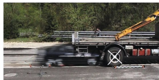
Nissan tampona l'asse posteriore del FBW ca. 70 ms
