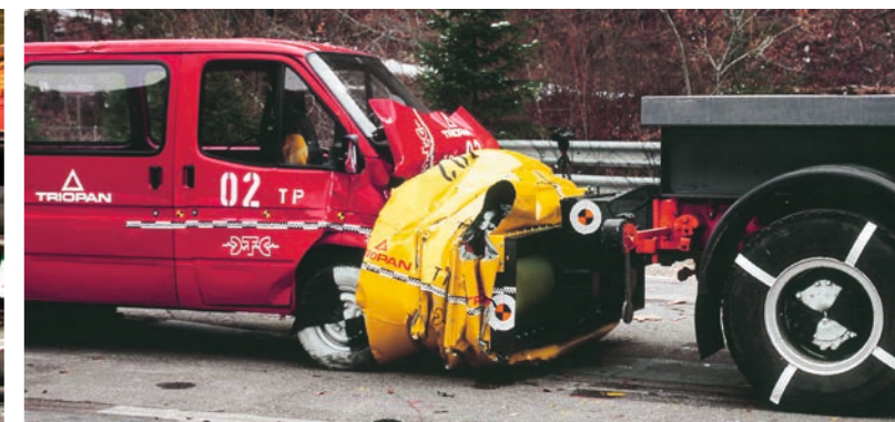
TMA e zona deformabile hanno garantito un'efficiente e protettiva trasformazione dell'energia
