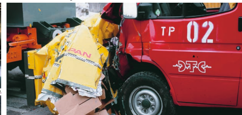
TMA e zona deformabile hanno garantito un'efficiente e protettiva trasformazione dell'energia
