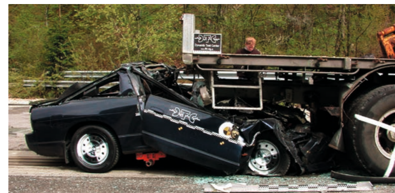
Impatto dell'asse posteriore sulla parte anteriore della Nissan
