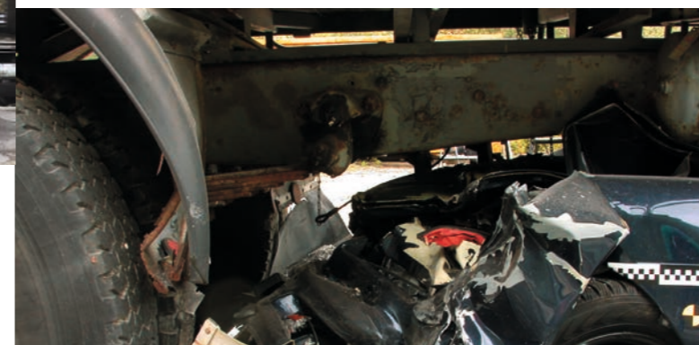
Impatto dell'asse posteriore sulla parte anteriore della Nissan
